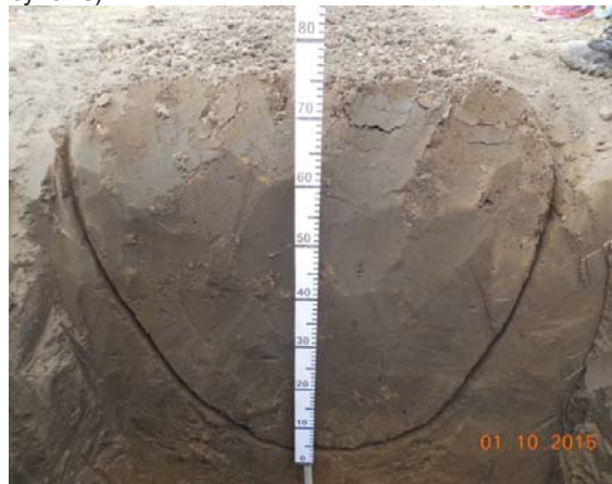
Рисунок 3. Фактичний контур зони зволоження за КЗ супіщаного ґрунту, варіант 3,0 м 3 /100 м ряду
