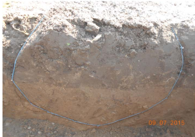
Рисунок 5. Фактичний контур зони зволоження за КЗ середньо-суглинкового ґрунту, варіант 3,6 м³/100 м ряду (КДДС)
