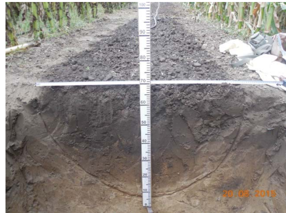
Рисунок 1. Фактичний контур зони зволоження за КЗ легкосуглинкового ґрунту, варіант 3,6 м 3 /100 м ряду (ДП «ДГ «Брилівське» ІВПіМ)
